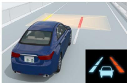
このハンドルの動きに車両が反応し、車線を逸脱しそうになると警報や表示でドライバーに知らせます。
