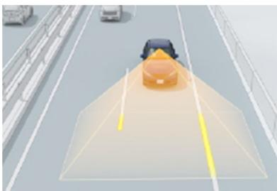
光学式カメラセンサーは、車線に対応した白線をつねに監視しています。
