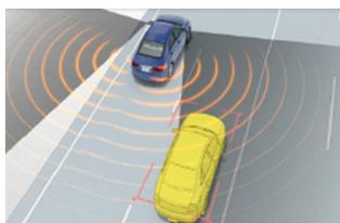
車両後部のセンサーによって、ドライバーの死角になる斜め後方の車を検知します
